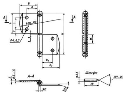
Рисунок Б.13 - Пример накладной петли типоразмера ПН-115
