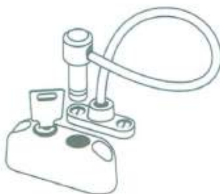
Рисунок Б.8 — Пример ограничителя поворотного (распашного) режима в виде гибкого троса с замком
