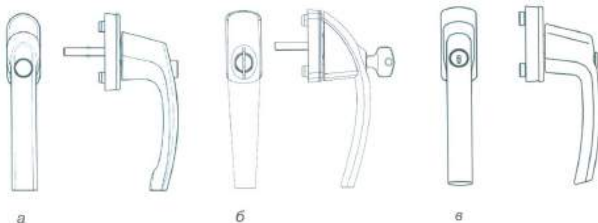
а — оконная ручка с кнопкой; б — оконная ручка со встроенным цилиндрическим механизмом с ключом; в — оконная ручка со встроенным цилиндрическим механизмом и ключом для откидно-поворотного способа открывания створки
